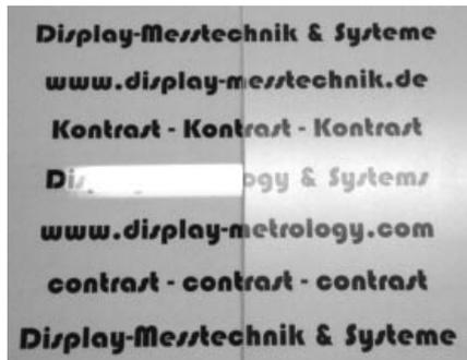
Die linke Hälfte des Bildes zeigt, wie eine Lichtquelle (Leuchtstoffröhre) von einem Röhrenmonitor reflektiert wird, rechts die gleiche Lichtquelle durch einen Flachbildschirm reflektiert.
